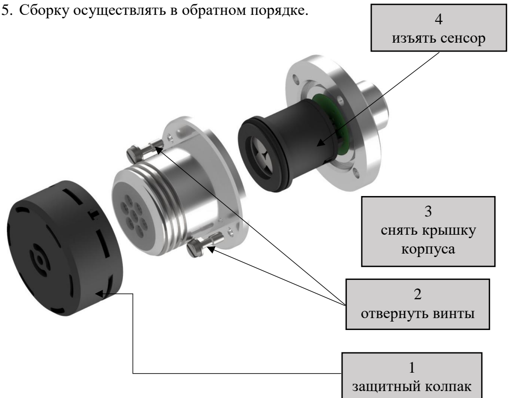
Рисунок 14 - Порядок замены оптического сенсора
